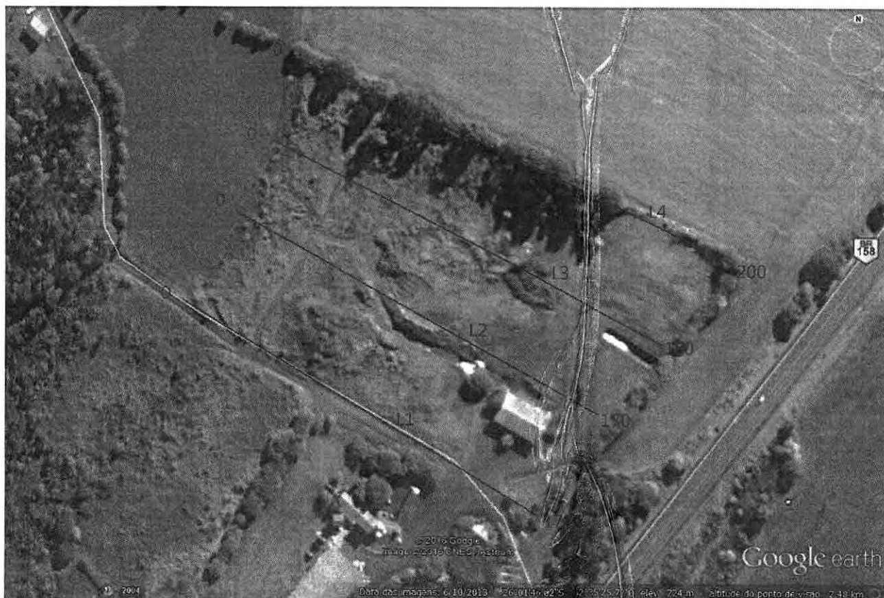
Figura 1 – Proposta de locação das linhas geofísicas L1, L2, L3 e L4 na área de encerramento das operações de deposição de lixo de Coronel Vivida-PR.
