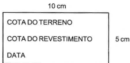
Figura 2 - Placa de identificação do poço
