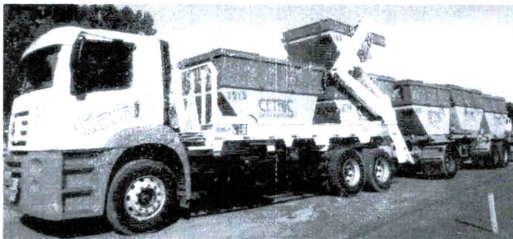
Figura 02 – Caminhão Poliguindaste (Contêineres de 4, 6 e 7 m 3 ).
