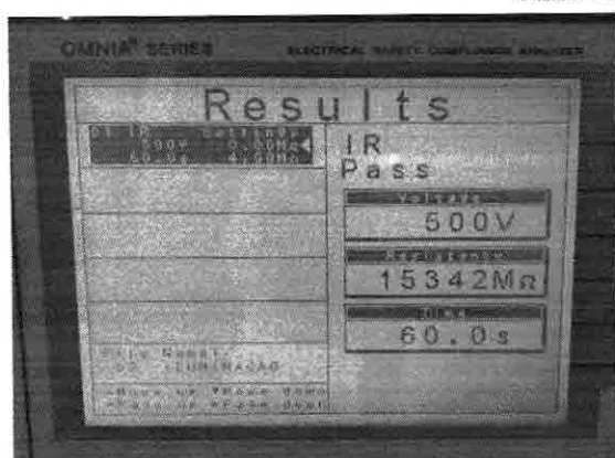
II.A.2.1.2 - Ensaio de resistência de isolamento da tomada do relé fotoelétrico - contatos da tomada lig. duas a duas
