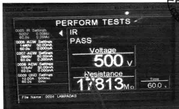
II.A.5.2 - Ensaio de resistência de isolamento da luminária - Entre partes vivas de polaridades diferentes
