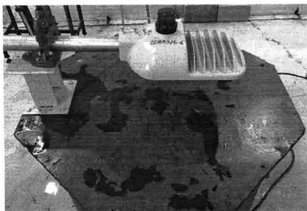
IPX6 - Posicionamento da amostra para ensaio de água.
