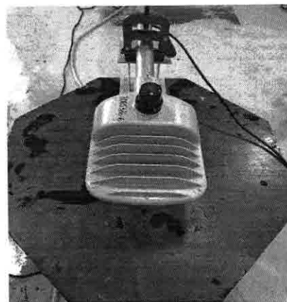
IPX6 - Posicionamento da amostra para ensaio de água.
