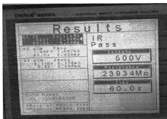
II.A.5.2 - Ensaio de resistência de isolamento da luminária - isolamento da bucha do cordão de alimentação
