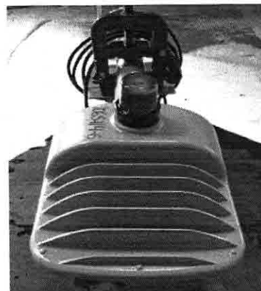
IPX6 - Posicionamento da amostra para ensaio de água.
