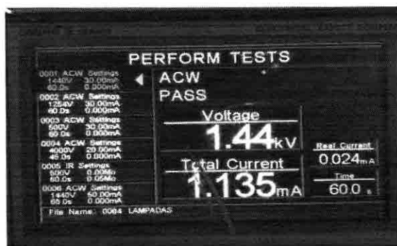
II.A.5.1 - Ensaio de rigidez dielétrica da luminária - Entre partes vivas de polaridades diferentes
