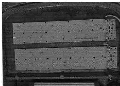
IP6X - Evidência de NÃO penetração de pó no compartimento óptico.
