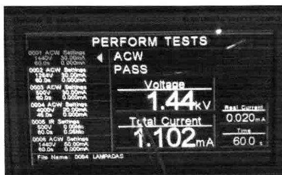
II.A.5.1 - Ensaio de rigidez dielétrica da luminária - Entre partes vivas de polaridades diferentes
