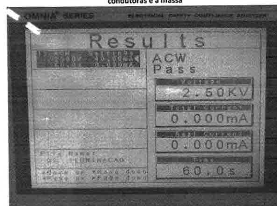
II.A.2.1.2 - Ensaio de Rigidez dielétrica da tomada do relé fotoelétrico - Partes condutoras e a massa
