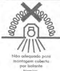
Não adequado para montagem coberta por isolante térmico.
