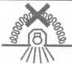
Não adequada para montagem coberta por isolante térmico.
