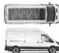
L3H3 Furgão com capacidade volumétrica de carga de 12,4m³ e categoria "B" de habilitação.
