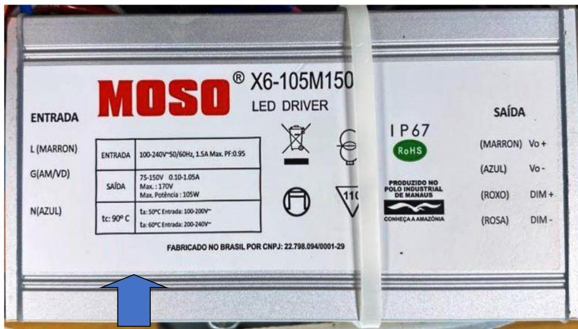
A tensão de alimentação trabalha em 50 °C de 100-200V e em 60°C de 200-240V, chegando em sua faixa de tensão até 305 V.
