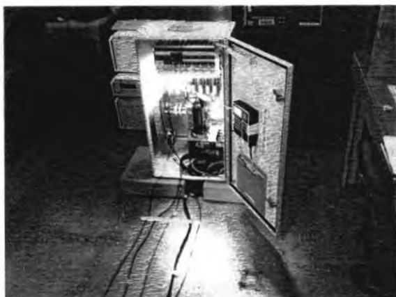
Fotos 41 e 42 – Imunidade a redução e à interrupção da tensão da rede elétrica
