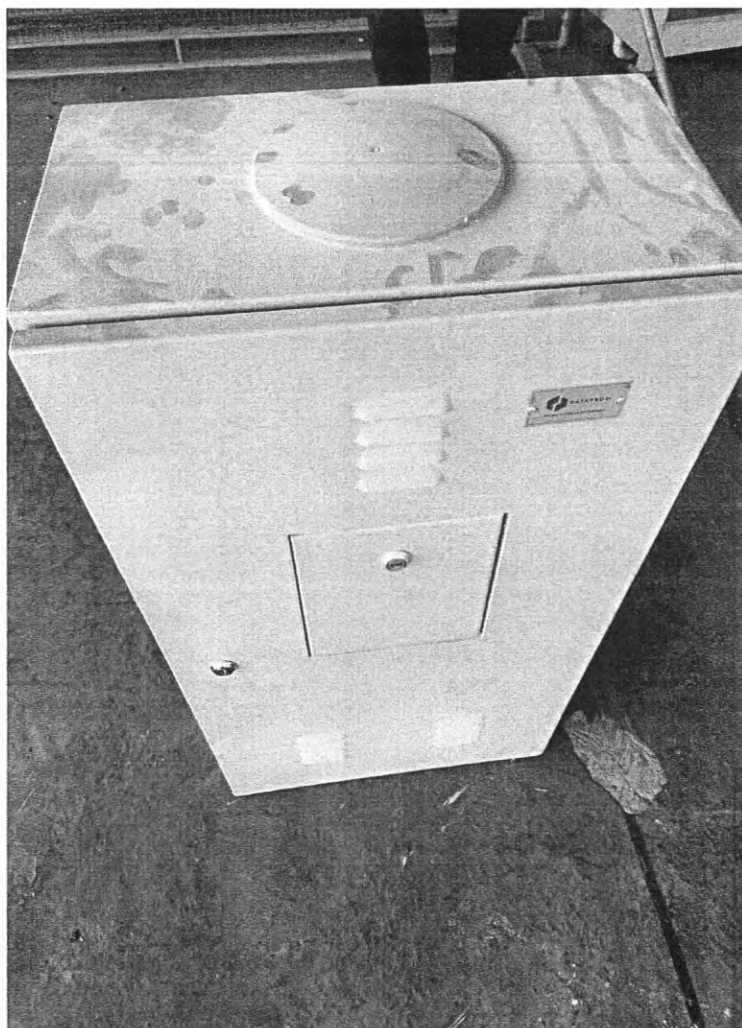
Figura 4 – Amostra logo após teste de verificação de proteção contra poeira.
