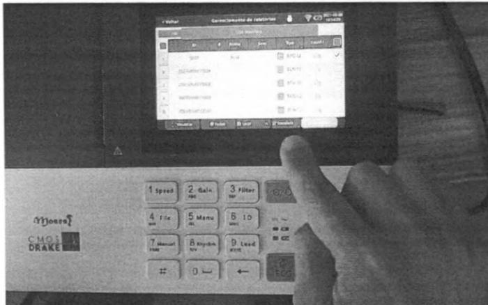
Figura 26 – Item Transferir disponível após inserir o pen-drive (lado direito do eletrocardiógrafo).
