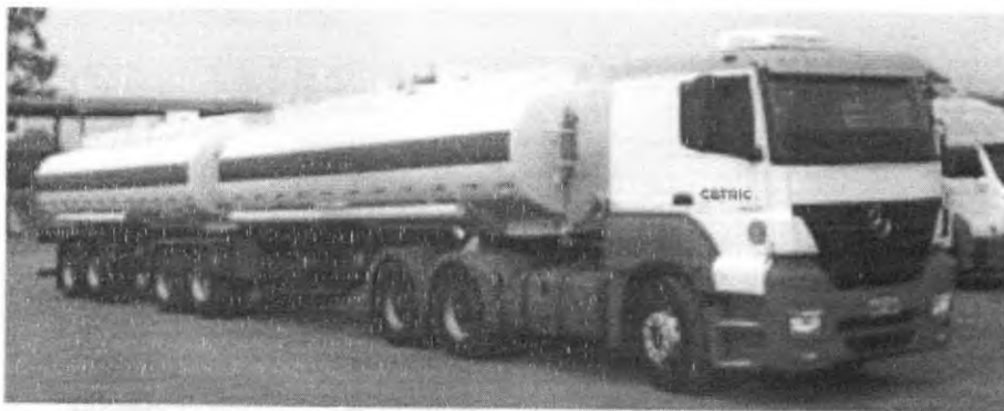
Figura 04 - Caminhão tanque e com bombeamento a vácuo
