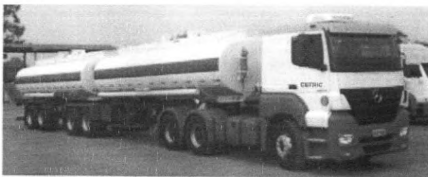
Figura 04 - Caminhão tanque e com bombeamento a vácuo
