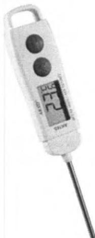
O AK16S é ideal para processos críticos onde medições com alta exatidão rápida são imprescindíveis. O instrumento possui haste de aço inox de comprimento e faixa de medição total de -50 a 200°C.
