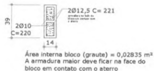
DETALHE PILAR EMBUTIDO NA ALVENARIA Escala: 1/15
