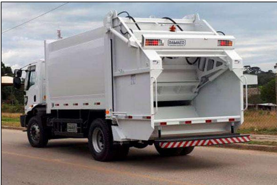
Figura 2: Caminhão coletor tipo compactador utilizado nos serviços de coleta convencional de RSU.
