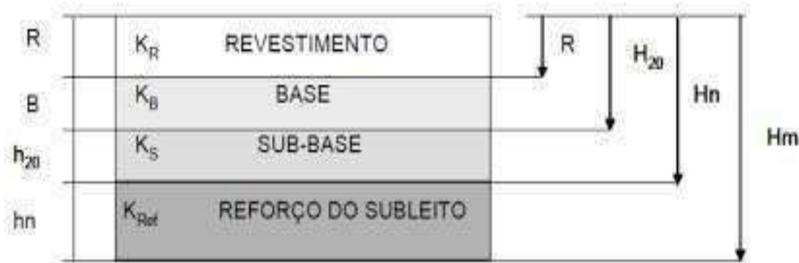
Figura 03. Dimensionamento de pavimento flexível
